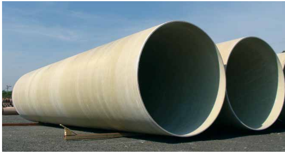
巴西 Amitech 公司可以使用纤维缠绕和离心过滤技术制造管道。
